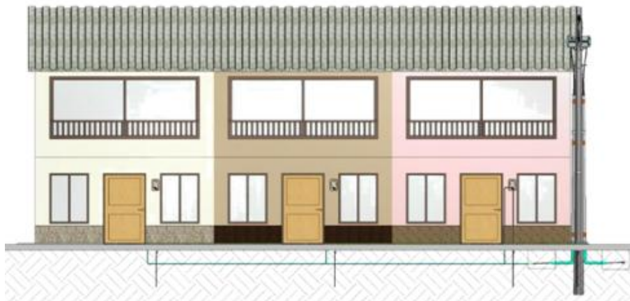
Figura 7. Canalizaciones subterráneas – Acometida subterránea.
