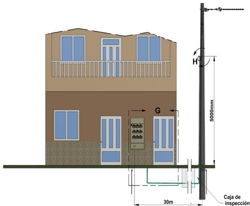
Figura 8. Acometida múltiple. Tablero para múltiples medidores de energía.
