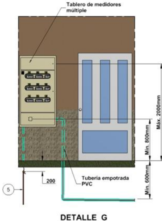
Figura 9. Detalle de instalación de tablero para múltiples medidores en fachada.
